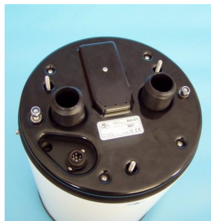
Pohled zdola na srážkoměr MR3H-FC s instalovanou jednotkou AH-01
